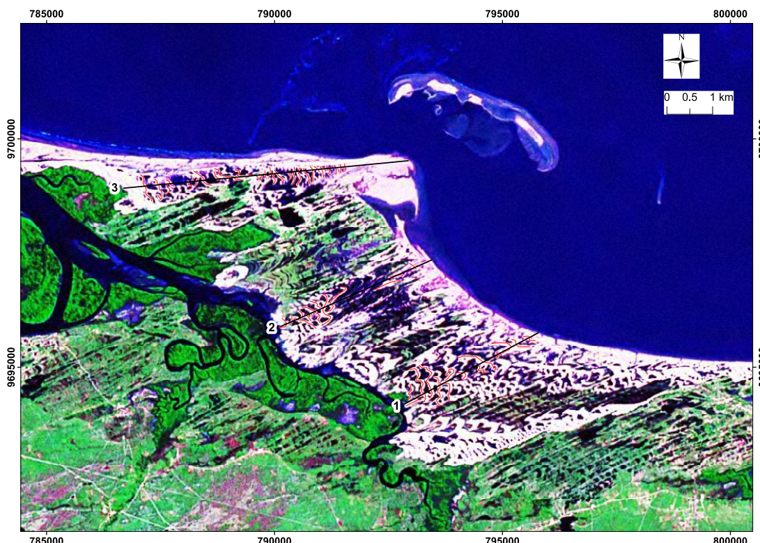
Figura 21. Três perfis (linhas em preto 1 a 3, orientadas de NE para SW) traçados para quantificação de parâmetros morfoplanimétricos de Ewing et al. (2006) no campo de dunas de Tutoia. Linhas finas laranjas correspondem às cristas de dunas mapeadas.
